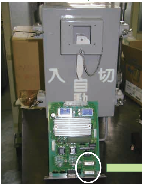
監視システム内に返信用リレーとして、採用されている基板実装RI-D24T2形リレー
