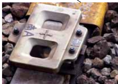
Spulenschnittstelle auf den Gleisen (Empfänger; Niederspannungsresonanzkreislauf) Die maßgeschneiderte Produkte.
